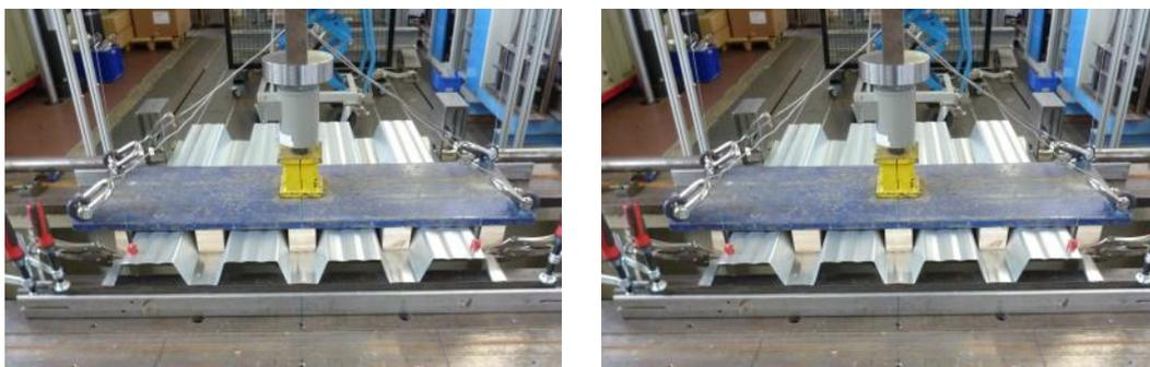
**Abbildung 1.3.2** – Bestimmung der Endauflagerkraft
