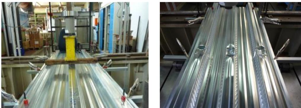
**Abbildung 1.3.3** – Bestimmung der Zwischenauflegerkraft
