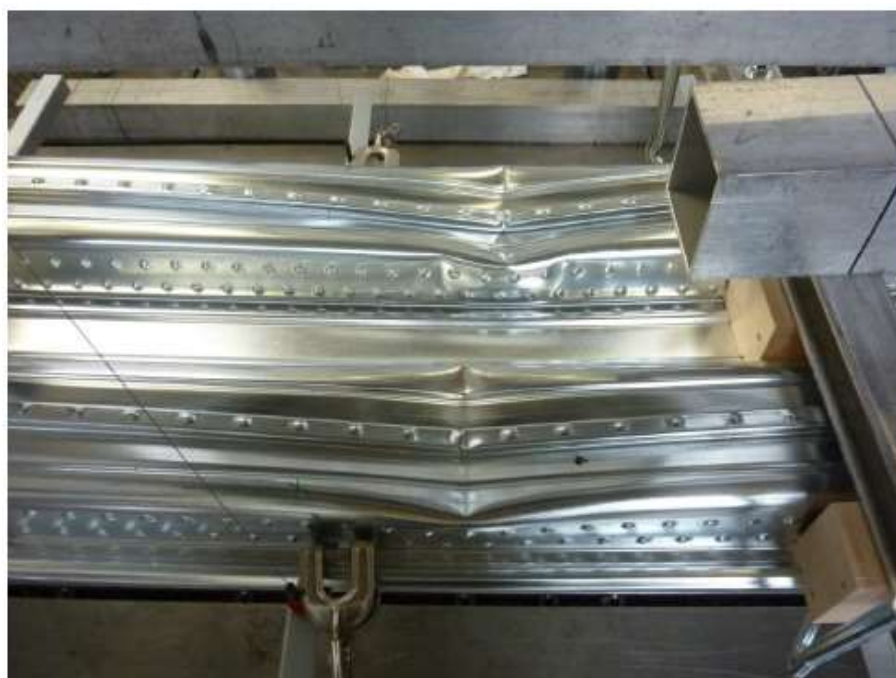
Rysunek 1.3.2 – Blacha po badaniu
