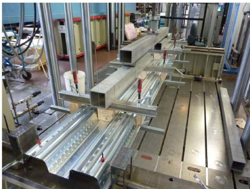
Rysunek 1.3.1 – Badania wytrzymałości na moment przęsłowy
