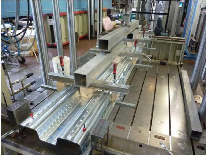
**Abbildung 1.3.1** – Prüfung eines Einfeldträgers
