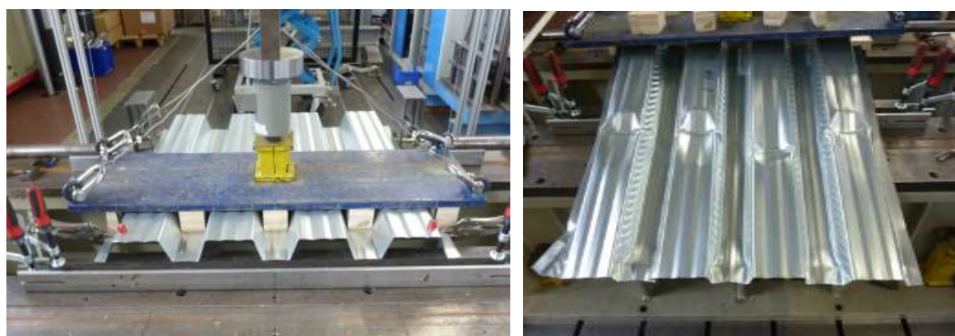
Figure 1.3.2 – Test sull'appoggio di estremità
