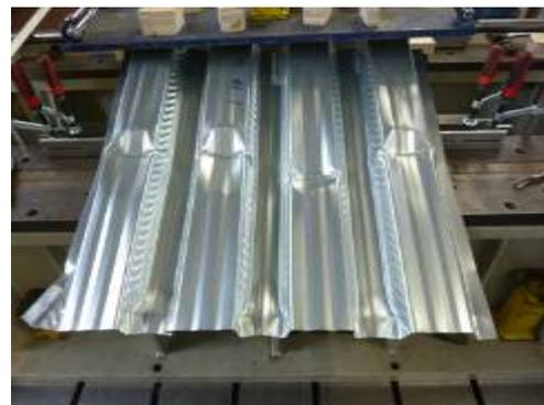
**Figure 1.3.2** – Essai d'appui d'extrémité
