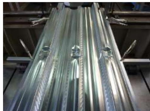
**Figure 1.3.3** – Essai d'appui intérieur
