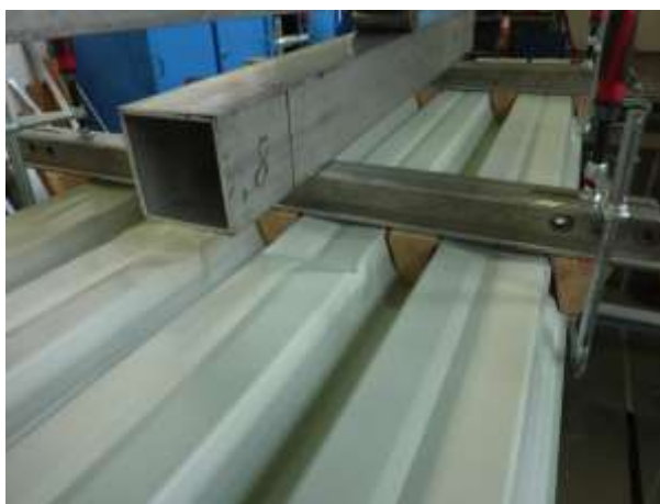
Rysunek 1.3.1 – Badania wytrzymałości na moment przęsłowy blachy bez otworów
