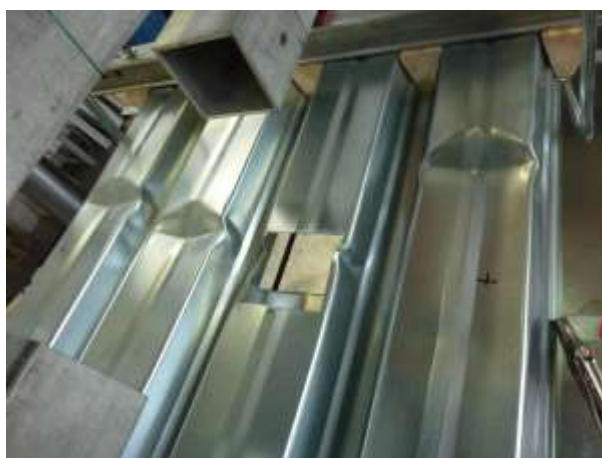
Rysunek 1.3.3 – Badania wytrzymałości na moment przęsłowy blachy z otworem kwadratowym
