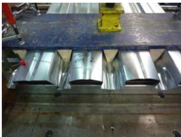
Figura 1.3.5 – Test all'appoggio su lamiere senza perforazioni
