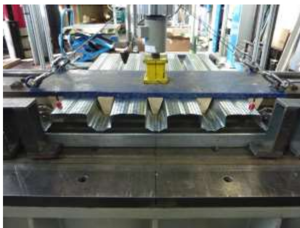
Figura 1.3.8 – Test all'appoggio su lamiere con perforazioni su anime e flange
