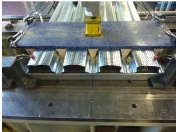
Figura 1.3.7 – Test all'appoggio su lamiere con perforazioni sulle flange
