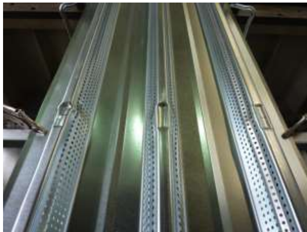
Figura 1.3.10 – Lamiera con perforazioni sulle anime dopo un test sull'appoggio interno
