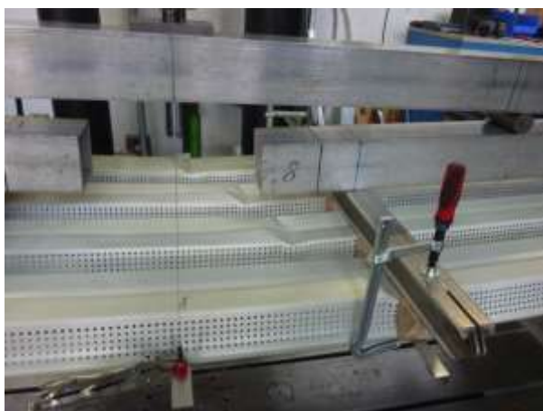
Figura 1.3.2 – Test su una singola campata con perforazioni sulle anime
