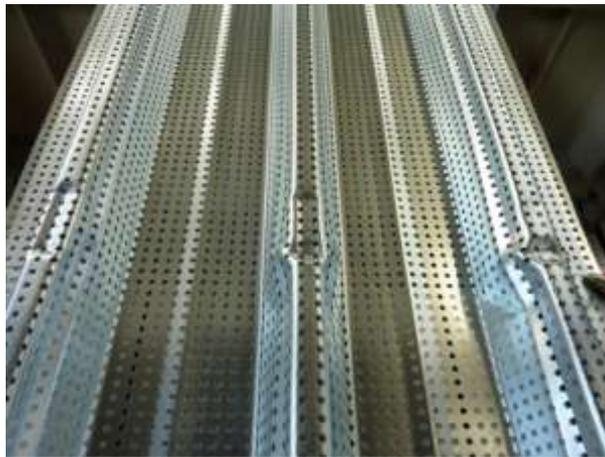
**Abbildung 1.3.12** – Zwischenauflagerversuch am Profil mit vollständiger Perforation
