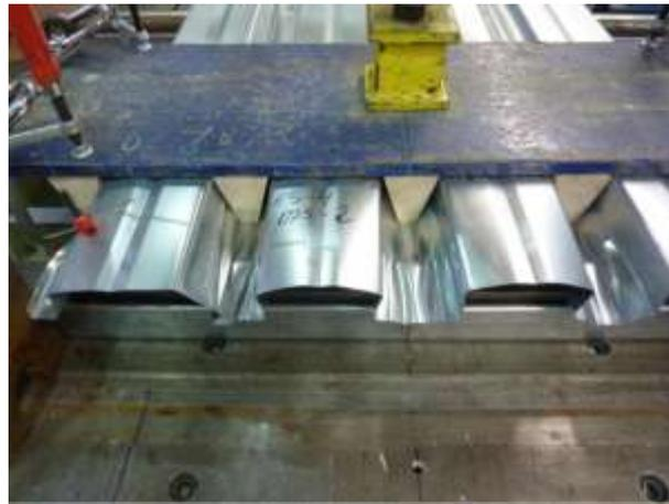
**Abbildung 1.3.5** – Endauflagerversuch am Profil ohne Perforation
