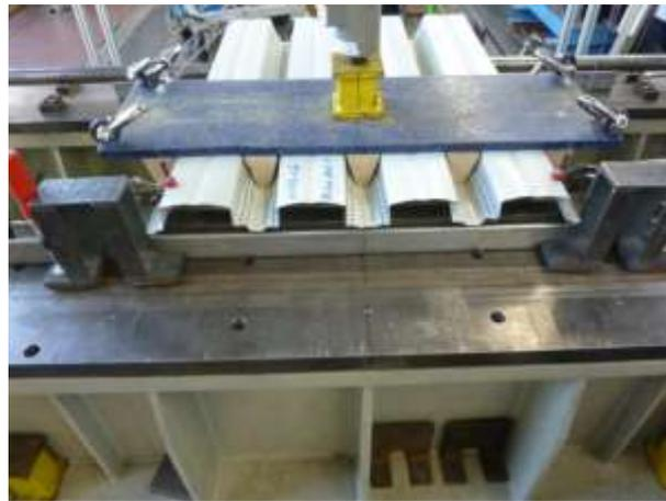
**Abbildung 1.3.6** – Endauflagerversuch am Profil mit Perforationen im Steg
