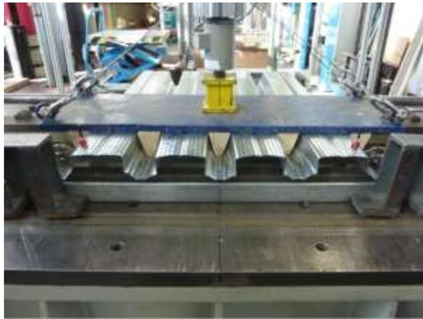
**Abbildung 1.3.8** – Endauflagerversuch am Profil mit vollständiger Perforationen
