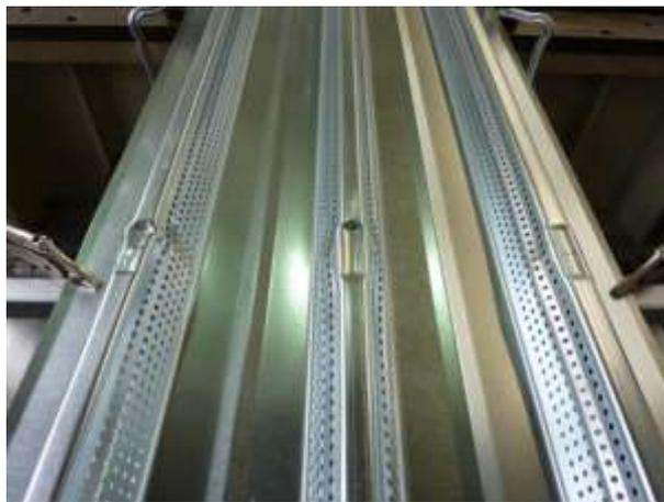
**Abbildung 1.3.10** – Zwischenauflagerversuch am Profil mit Perforationen im Steg
