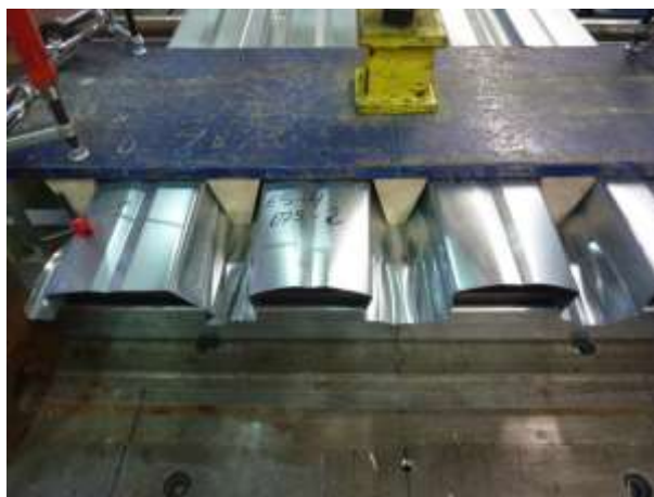
Rysunek 1.3.5 – Badania wytrzymałości na podporze skrajnej nie perforowanej
