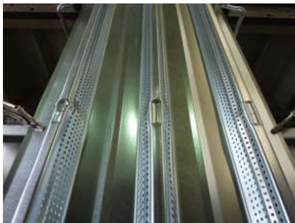
Rysunek 1.3.10 – Profil perforowany w środkach po badaniach wytrzymałości na podporze pośredniej
