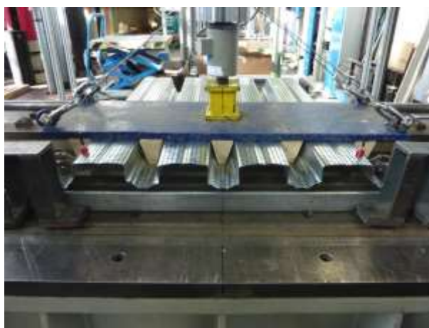
Rysunek 1.3.8 – Badania wytrzymałości na podporze skrajnej blachy całkowicie perforowanej
