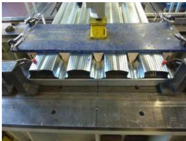
Rysunek 1.3.7 – Badania wytrzymałości na podporze skrajnej blachy perforowanej w górnych półkach
