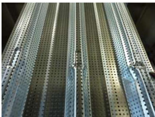
Rysunek 1.3.12 – Profil perforowany całkowicie po badaniach wytrzymałości na podporze pośredniej
