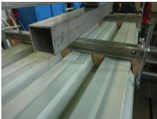
Rysunek 1.3.1 – Badania wytrzymałości na moment przęsłowy blachy nie perforowanej
