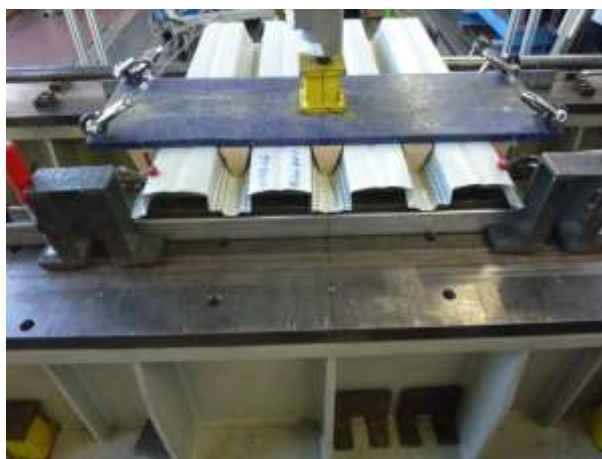
Rysunek 1.3.6 – Badania wytrzymałości na podporze skrajnej blachy perforowanej w środkach
