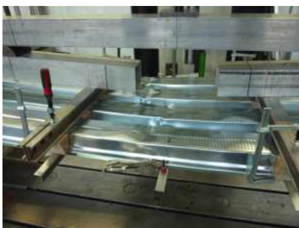
Rysunek 1.3.3 – Badania wytrzymałości na moment przęsłowy blachy perforowanej w górnych półkach
