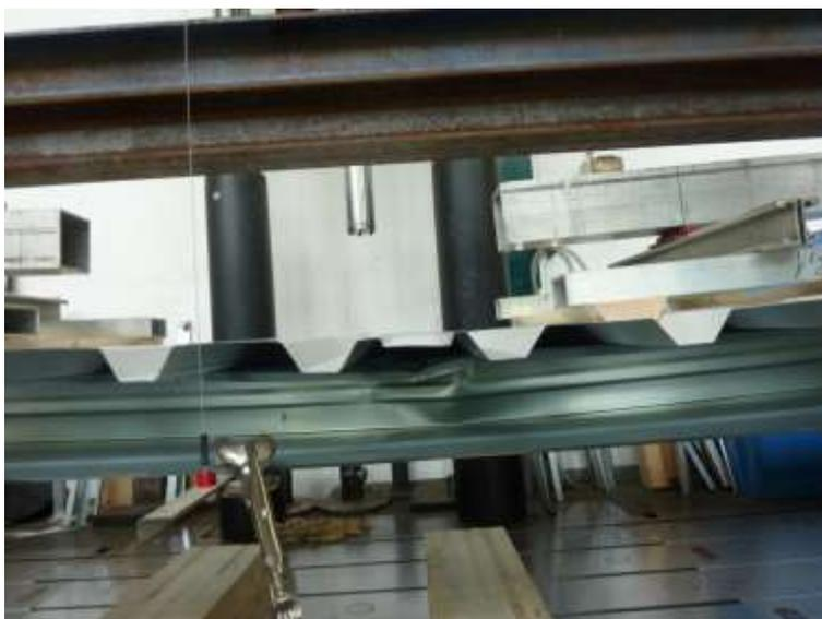
**Figura 1.3.3** – *Collasso per instabilità laterale delle flange compresse*
