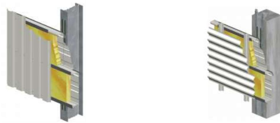
**Figura 1.2.1** – Sistema a muro per i profili considerati
