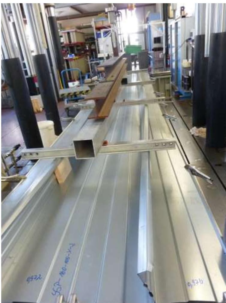
**Figura 1.3.4** – *Collasso per instabilità laterale delle flange compresse*
