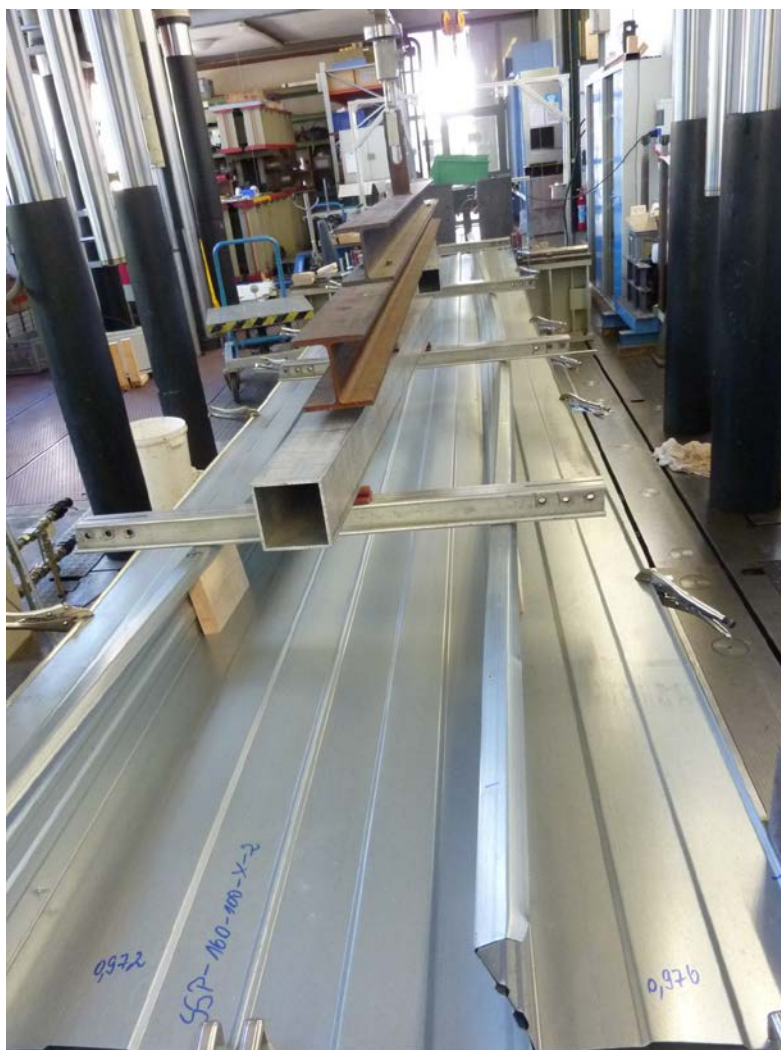
Rys. 1.3.4 – Zniszczenie kasety przez zwichrzenie ściskanych pasów kołnierza kasety – widok z góry
