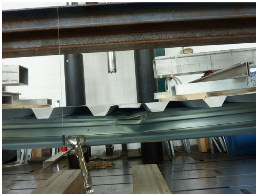
Rys. 1.3.3 – Zniszczenie kasety przez zwichrzenie ściskanych pasów kołnierza kasety
