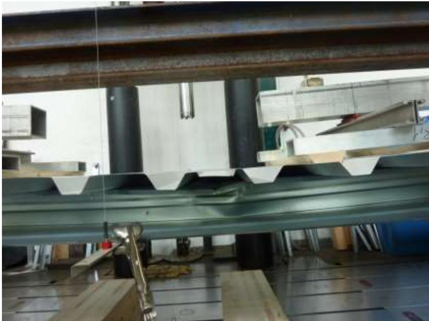
**Abbildung 1.3.3** – Versagen durch seitliches Knicken des Druckgurtes
