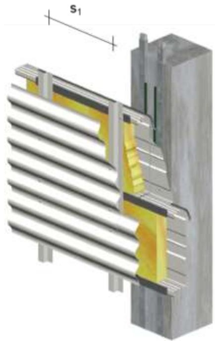
**Abbildung 9.1.3** – Kassettenprofilwand
