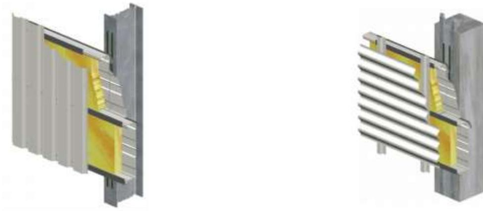
**Abbildung 1.2.1** – Kassettenprofilwände
