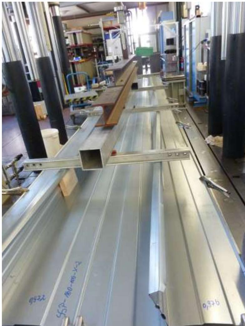
**Abbildung 1.3.4** – Versagen durch seitliches Ausweichen der schmalen Gurte
