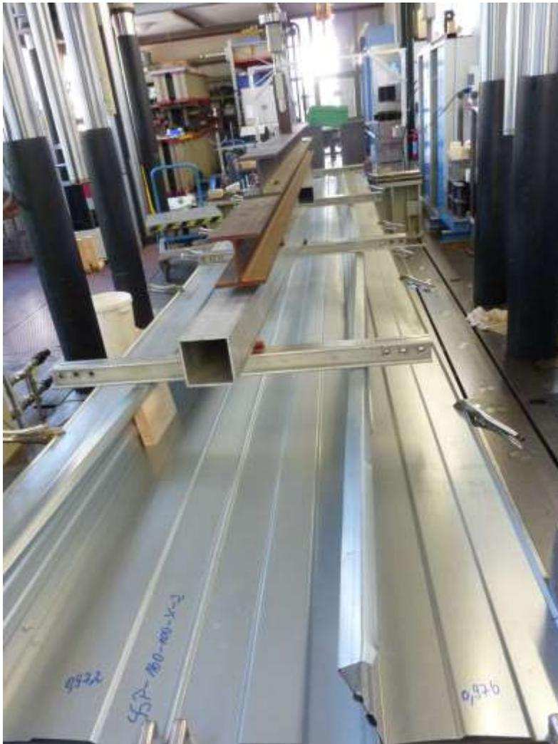
**Figure 1.3.4** – Ruine par flambement latéral de la semelle comprimée
