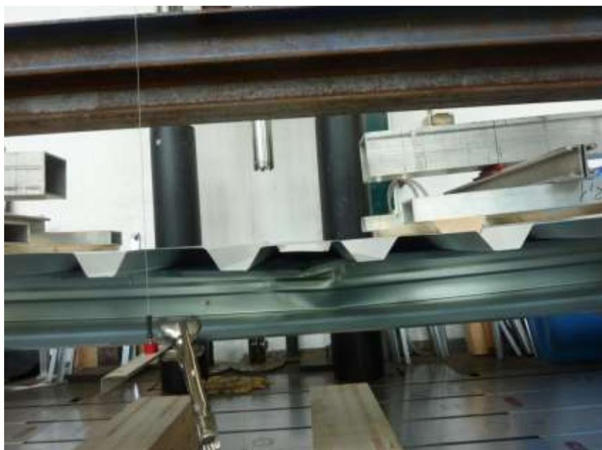
**Figure 1.3.3** – Ruine par flambement latéral de la semelle comprimée
