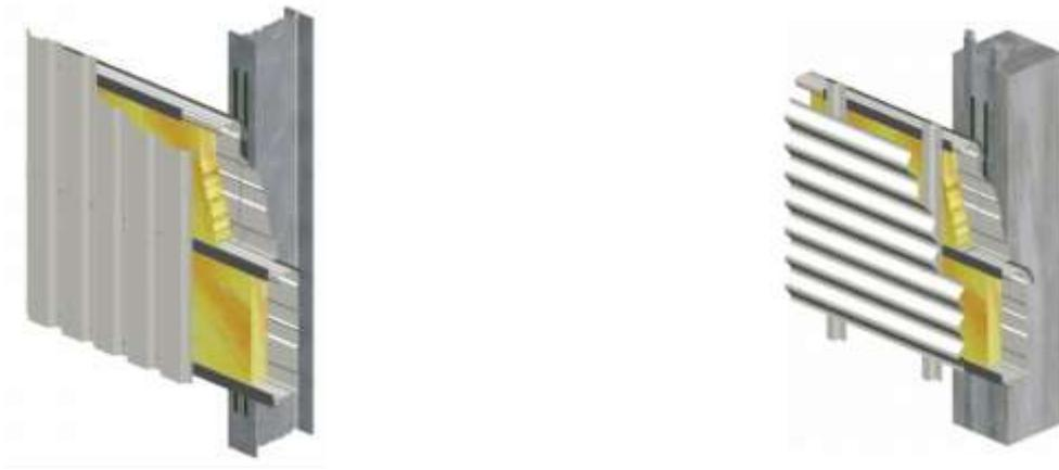
**Figure 1.2.1** – Systèmes de bardage avec plateaux
