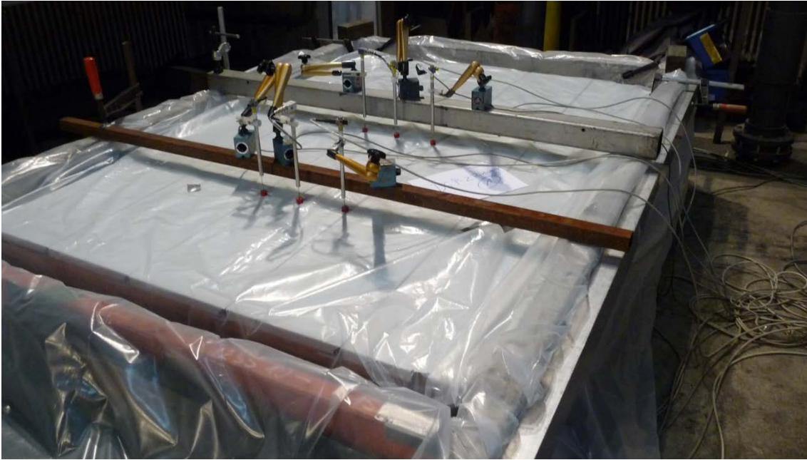
Rys. 1.5 Okładzina badana w teście zginania pojedynczego przęsła prowadzonym w komorze próżniowej (przyłożone obciążenie symuluje parcie wiatru).
