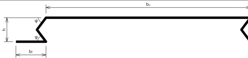
Rys. 10.10: Typowa geometria paneli liniowych okładzin stalowych
