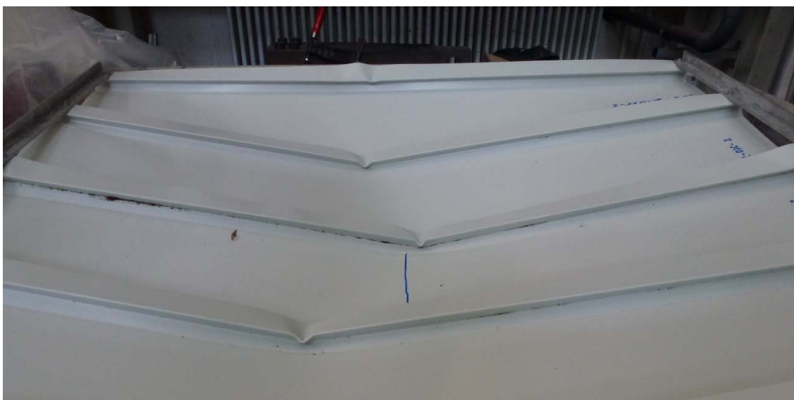
Rys. 1.8 Zniszczenie okładziny przez lokalne wyboczenie ścianek profilu w prowadzonym w komorze próżniowej teście zginania pojedynczego przęsła pod obciążeniem symulującym ssanie wiatru.
