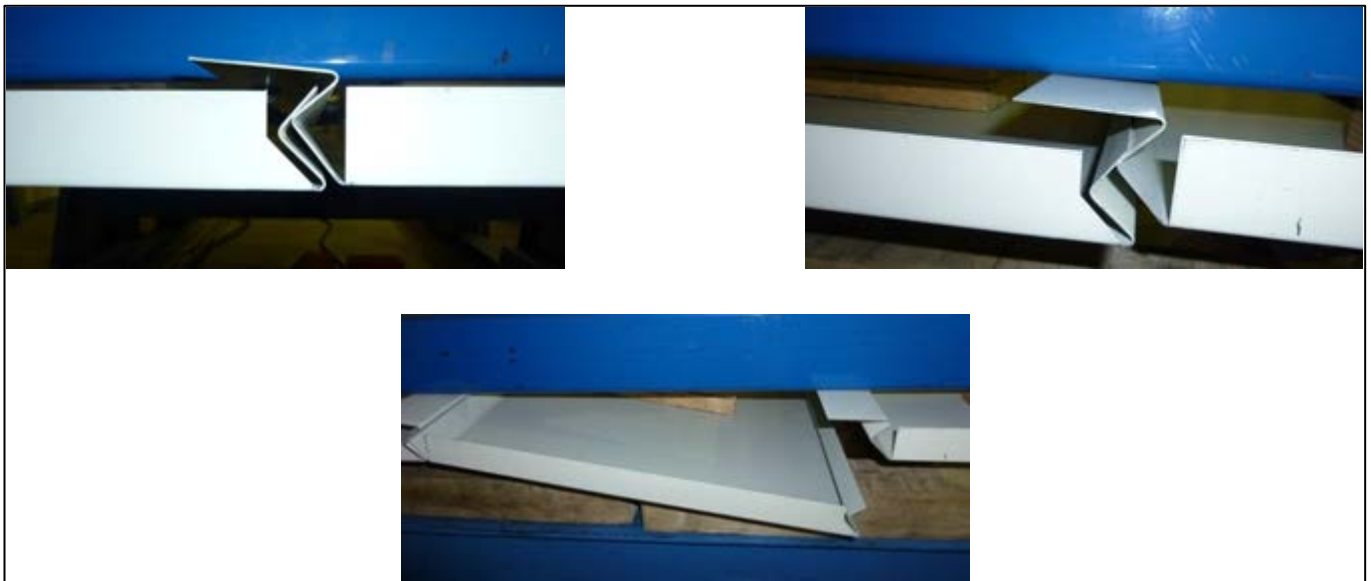
Rys. 1.4 Stopniowa dyslokacja okładzin łączonych w zamku obserwowana w testach pod obciążeniem symulującym ssanie wiatru
