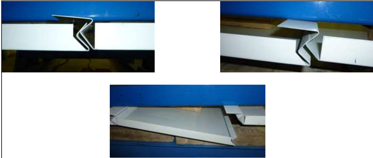
Figura 1.4 Graduale dislocazione del giunto durante i test eseguiti con carichi di aspirazione
