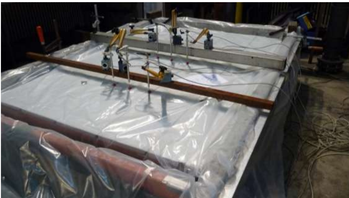
Abbildung 1.5 - Versuchskörper in der Vakuumkammer positioniert (Druckbelastung)
