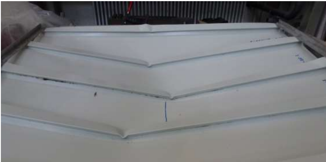
Abbildung 1.8 - Versagen der Gurtverbindungen durch lokales Beulen bei Einfeld-Biegeversuchen unter Sogbelastung
