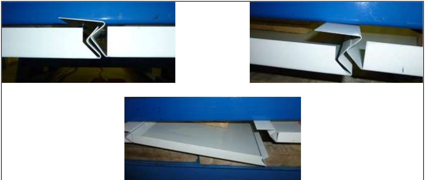
Abbildung 1.4 Stufenweise Verschiebung der Fugenkante unter Sogbelastung
