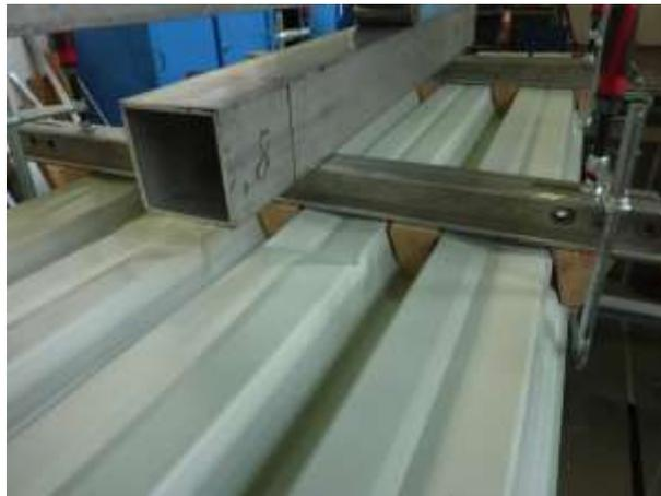
**Figura 1.3.1** – Test su una singola campata su una lamiera senza foro
