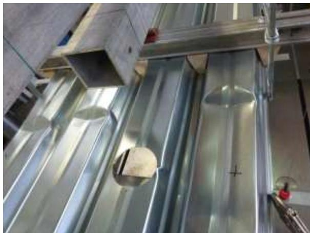
**Figura 1.3.2** – Test su una singola campata su una lamiera con un foro circolare
