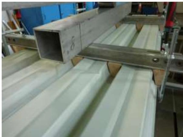
**Abbildung 1.3.1** – Versuch am Einfeldträger eines Profils ohne Öffnung
