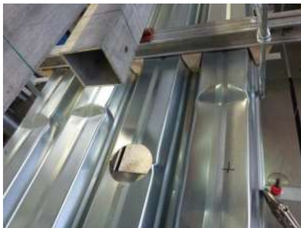
Figure 1.3.2 – Essai en travée simple sur plaque nervurée avec ouverture circulaire
