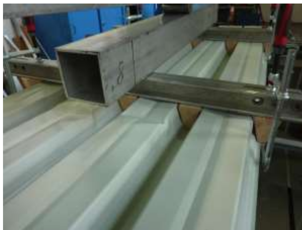
Figure 1.3.1 – Essai en travée simple sur plaque nervurée sans ouverture
