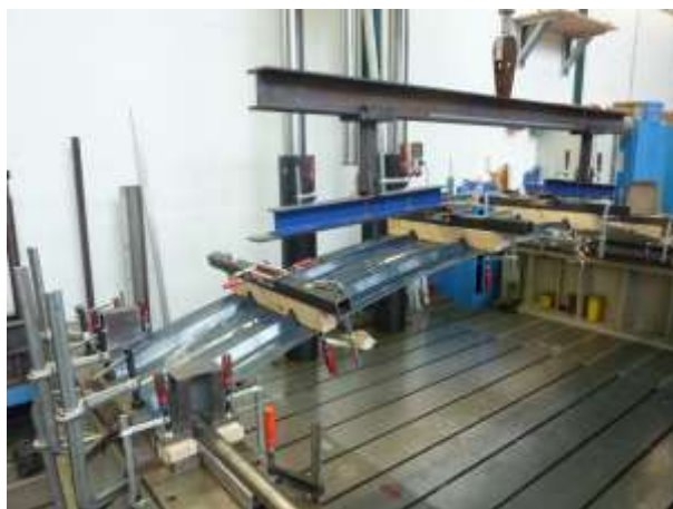
Figura 1-11: Immagine della configurazione del test su campata singola con supporto orizzontale (profilo 39/333).
