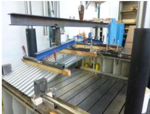
Figura 1-9: Immagine della configurazione del test su campata singola.
