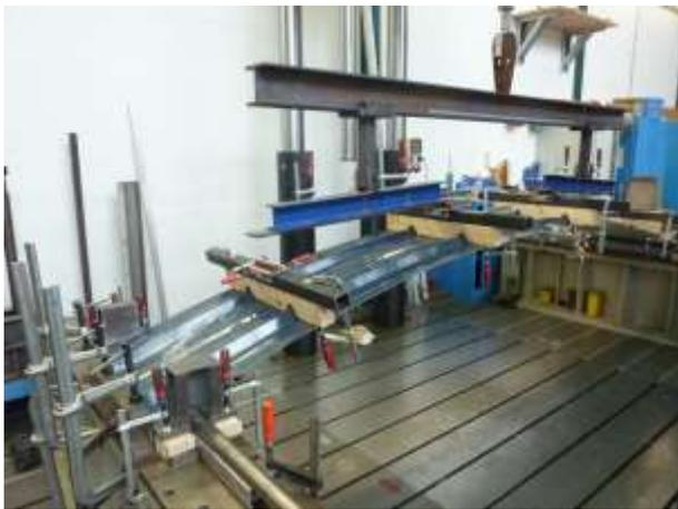
**Abbildung 1.3.6** - Foto des Versuchsaufbaus des Einfeldträger-Versuchs mit horizontaler Lagerung (Profil 39/333).
