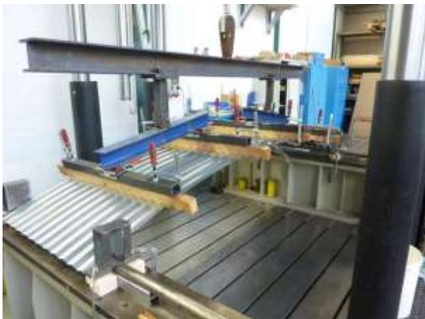
**Abbildung 1.3.4** - Foto des Versuchsaufbaus der Einfeldträger-Versuche.
