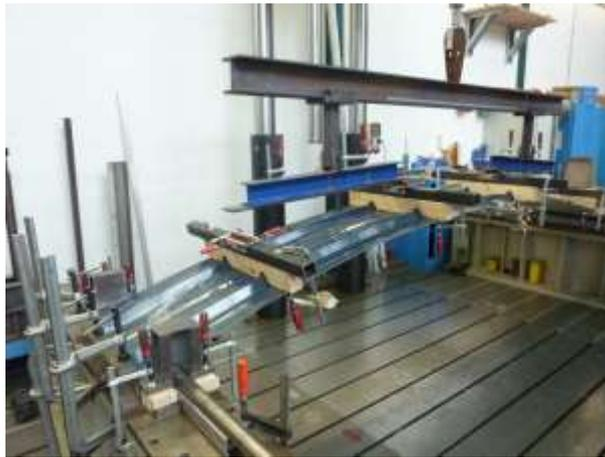
Figure 1-11: Photo du dispositif d'essai en travée simple avec supports horizontaux (profil 39/333).
