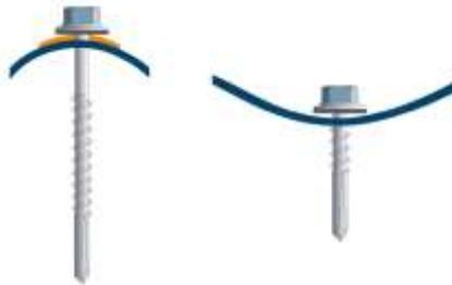
**Abbildung 1.1.2** – Verbindungselement auf dem Rippenobergurt (links) oder am Rippenuntergurt (rechts).
