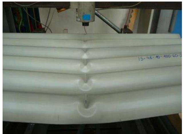
**Abbildung 1.3.4** – Schematischer Versuchsaufbau und Versagensbeispiel für einen Zwischenaufgerversuch unter andrückender Belastung.
