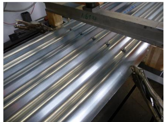
Rys. 1.3.5 – Schemat badania przeprowadzanego w teście podpory pośredniej w przypadku gdy podpora ta jest połączona z dolinami fałd, przy obciążeniu skierowanym w górę, oraz przykład zniszczenia arkusza blachy uzyskany w tym badaniu.
