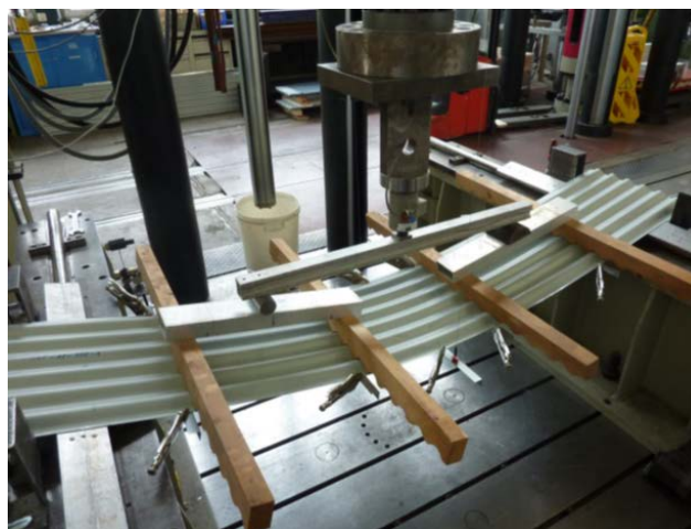
Rys. 1.3.3 – Schemat badania przeprowadzanego w teście pojedynczego przęsła i przykład zniszczenia arkusza blachy uzyskany w tym badaniu.
