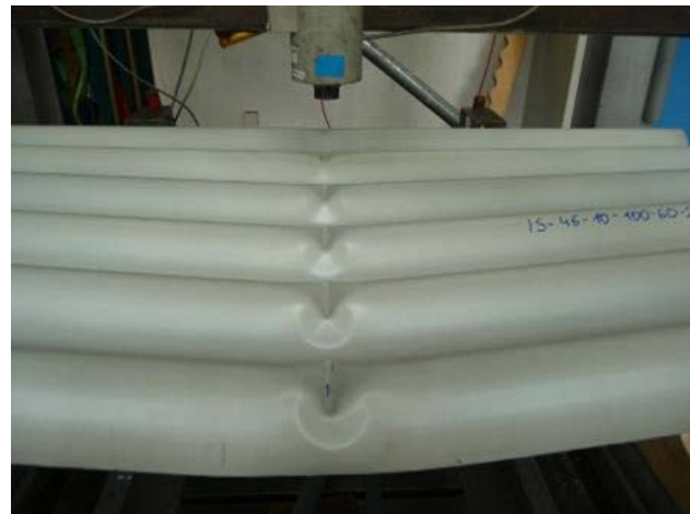
Rys. 1.3.4 – Schemat badania przeprowadzanego w teście podpory pośredniej przy skierowanym w dół obciążeniu typu grawitacyjnego oraz przykład zniszczenia arkusza blachy uzyskany w tym badaniu.
