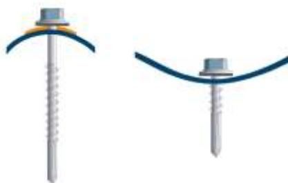
**Figura 1.1.2** – Fissaggio nella cresta (a sinistra) e fissaggio nell'avvallamento (a destra).
