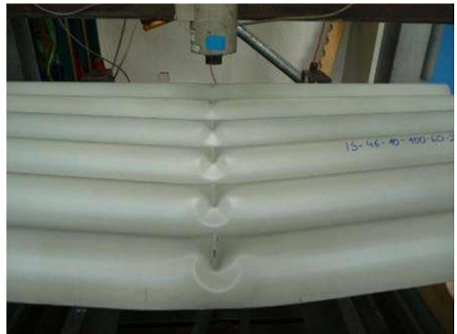
**Figura 1.3.4** – Configurazione schematica della prova sperimentale ed esempio di collasso per la prova su supporto interno a carichi gravitazionali.
