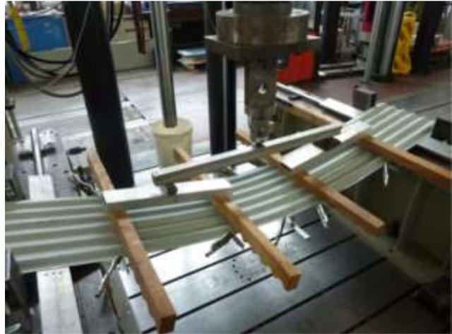
**Figura 1.3.3** – Configurazione schematica della prova sperimentale ed esempio di collasso per la prova su campata singola.
