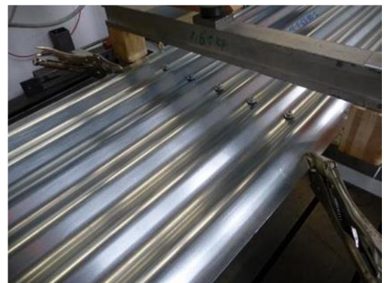
Figure 1.3.5 – Principe schématique de l'essai et exemple de rupture (fixation en fond de vallée) pour un test d'appui intermédiaire simulé avec chargement de succion.
