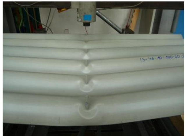
Figure 1.3.4 – Principe schématique de l'essai et exemple de rupture pour un test d'appui intermédiaire simulé avec chargement gravitaire.
