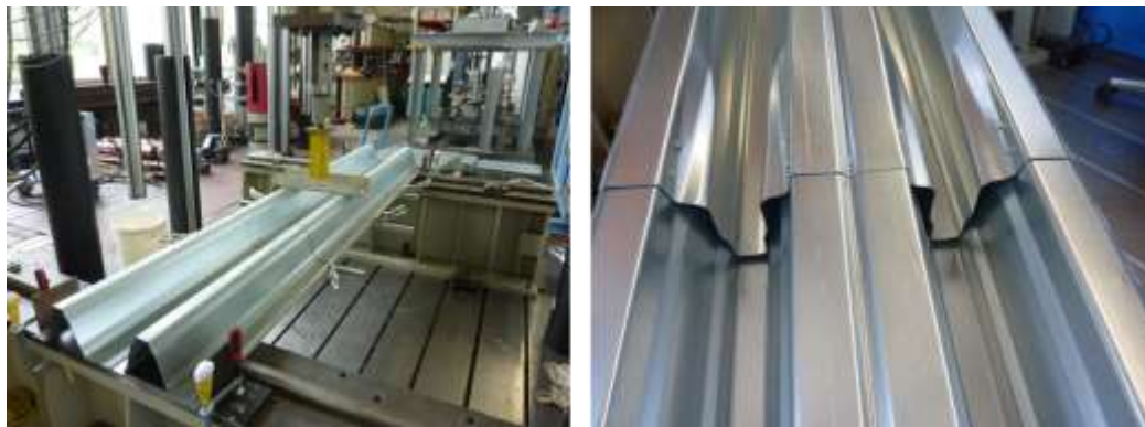
Figura 1.3.3 – Esempio della prova sul supporto intermedio e del collasso.
