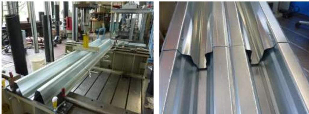
**Abbildung 1.3.3** – Beispiel für Versuche am Zwischenaufleger und Versagen
