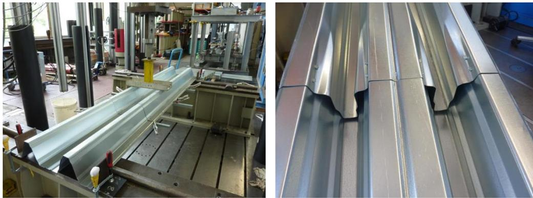
**Figure 1.3.3** – Exemple de ruine d’assemblage à l’issue d’un essai d’appui intermédiaire simulé.
